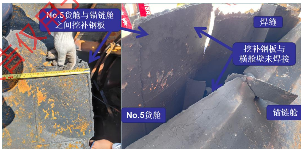
图 9：锚链舱与 No. 5 货舱甲板挖补示意图
