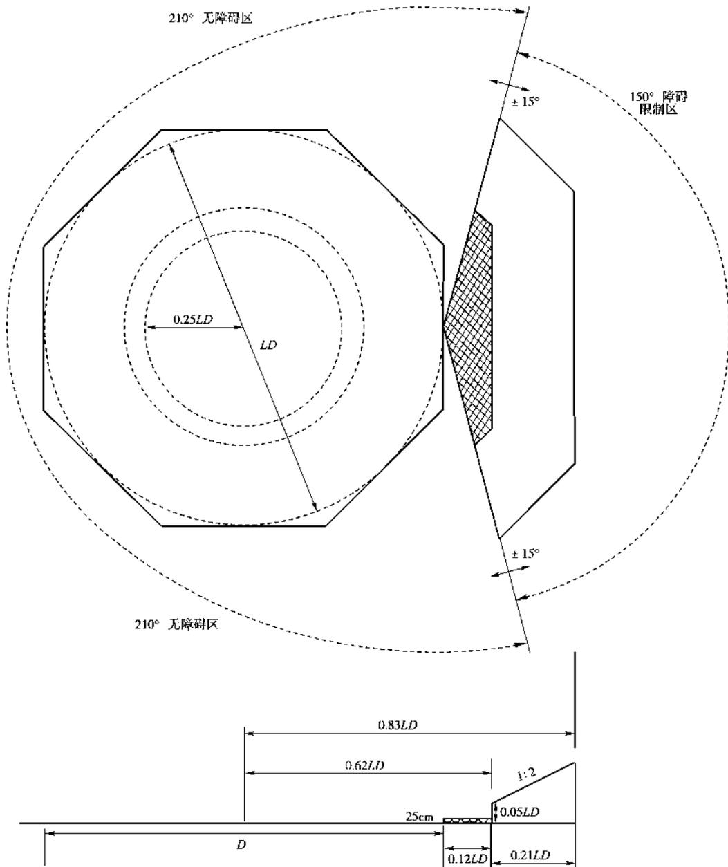
注 1: 如果最终抵/离区域周界标志以内的直升机甲板承载动力载荷区域的形状不是圆形, 则障碍限制区节段的范围不是用弧线, 而是用平行于降落区域周界的线段表示。图 11.3.1.2-2 系基于假定设有八边形直升机甲板而绘制。
