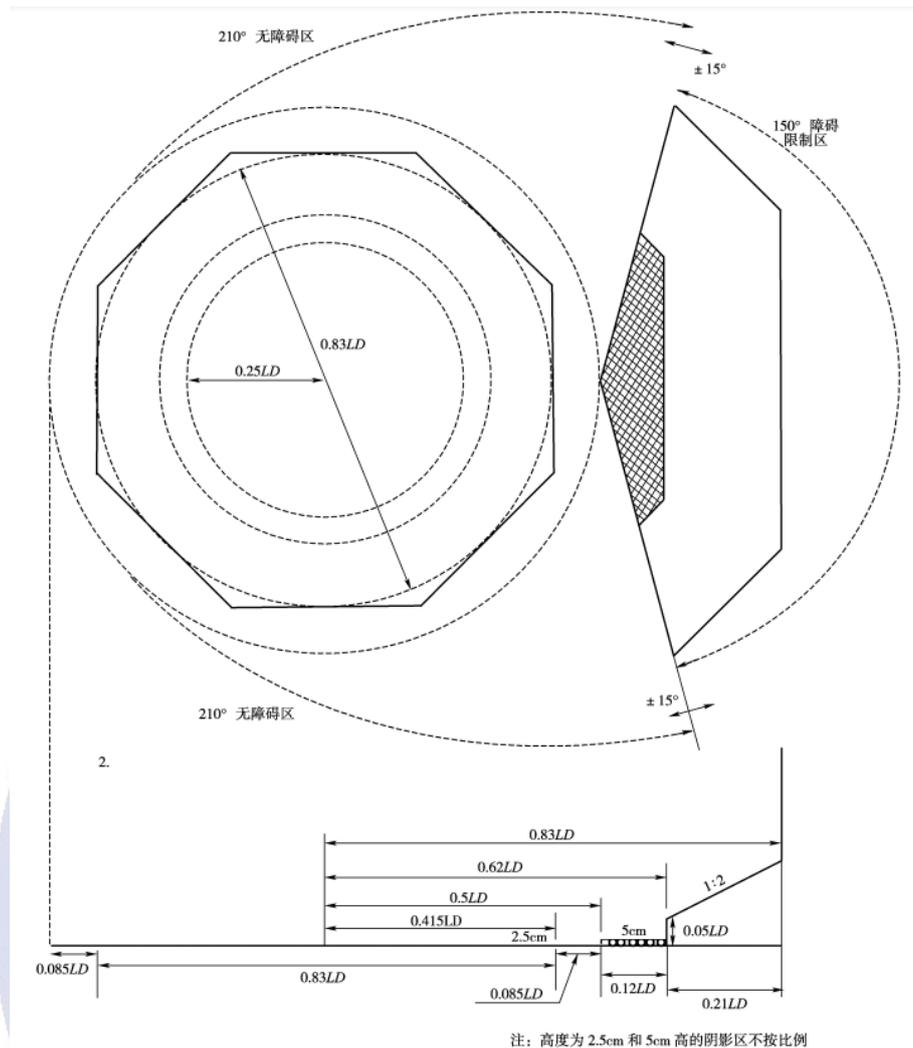
注 1: 如果最终抵/离区域周界标志以内的直升机甲板承载动力载荷区域的形状不是圆形, 则障碍限制区节段的范围不是用弧线, 而是用平行于降落区域周界的线段表示。图 11.5.5.1 系基于假定设有八边形直升机甲板而绘制。
