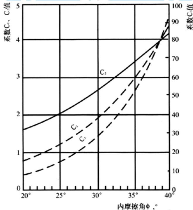
图 3.2.3.5 (1) 系数  $C$  和  $\phi$  的函数关系
