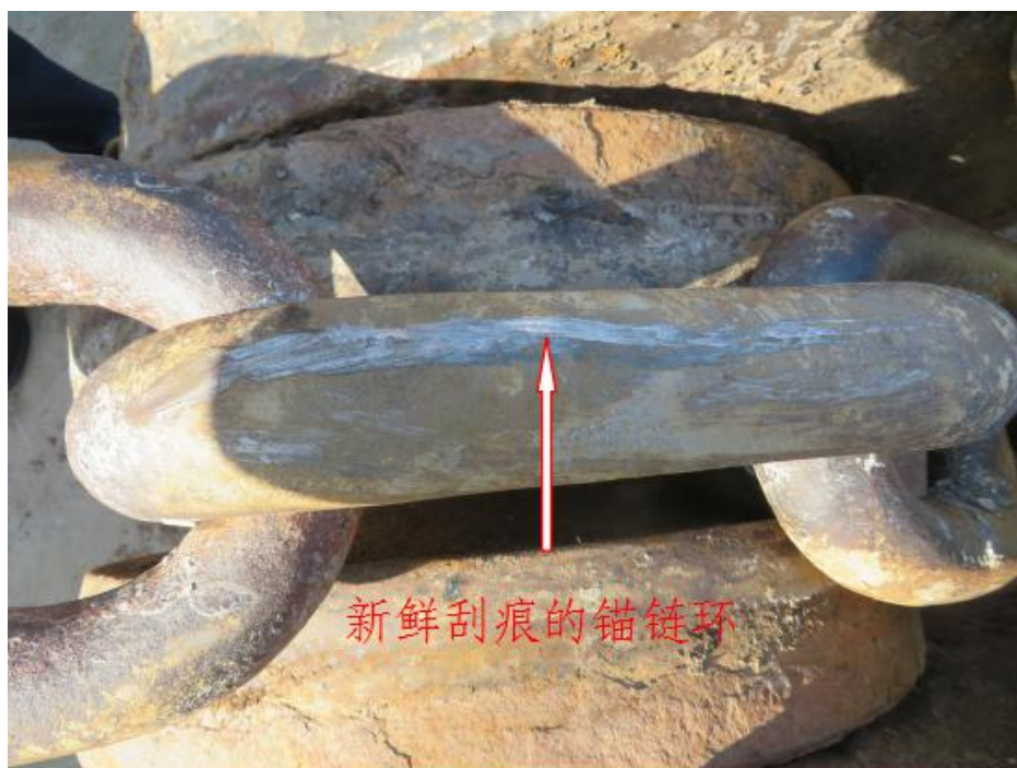
图 5：第一节锚链部分锚链环有新鲜刮痕
