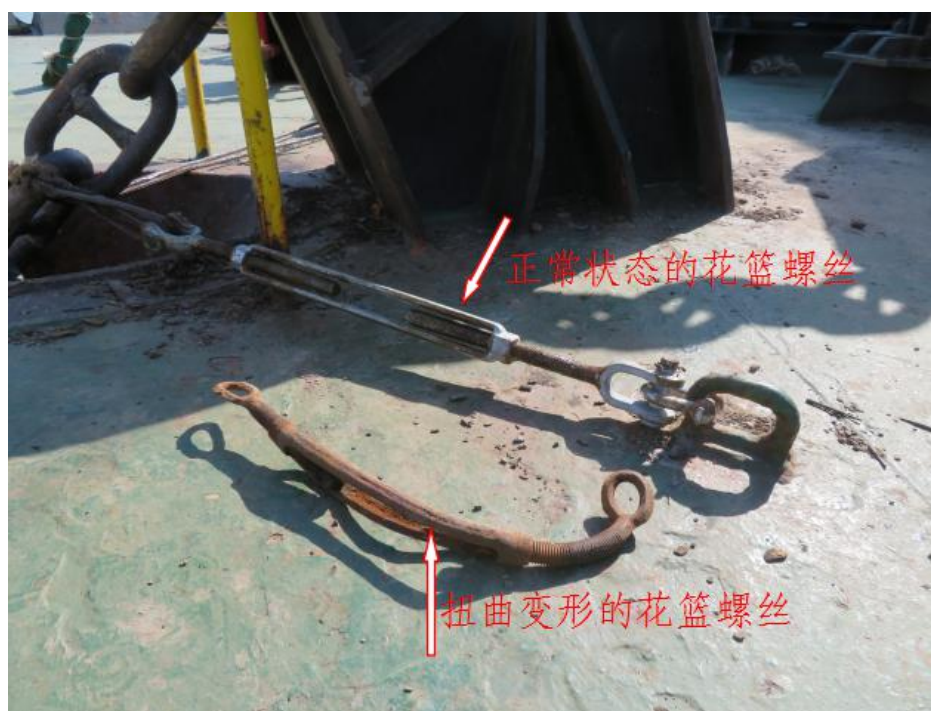
图 4：固定锚链的花篮螺丝
