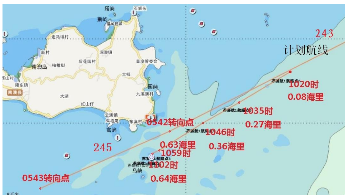
图三：“苏嘉航1”轮触礁前计划航向及航迹向示意图
