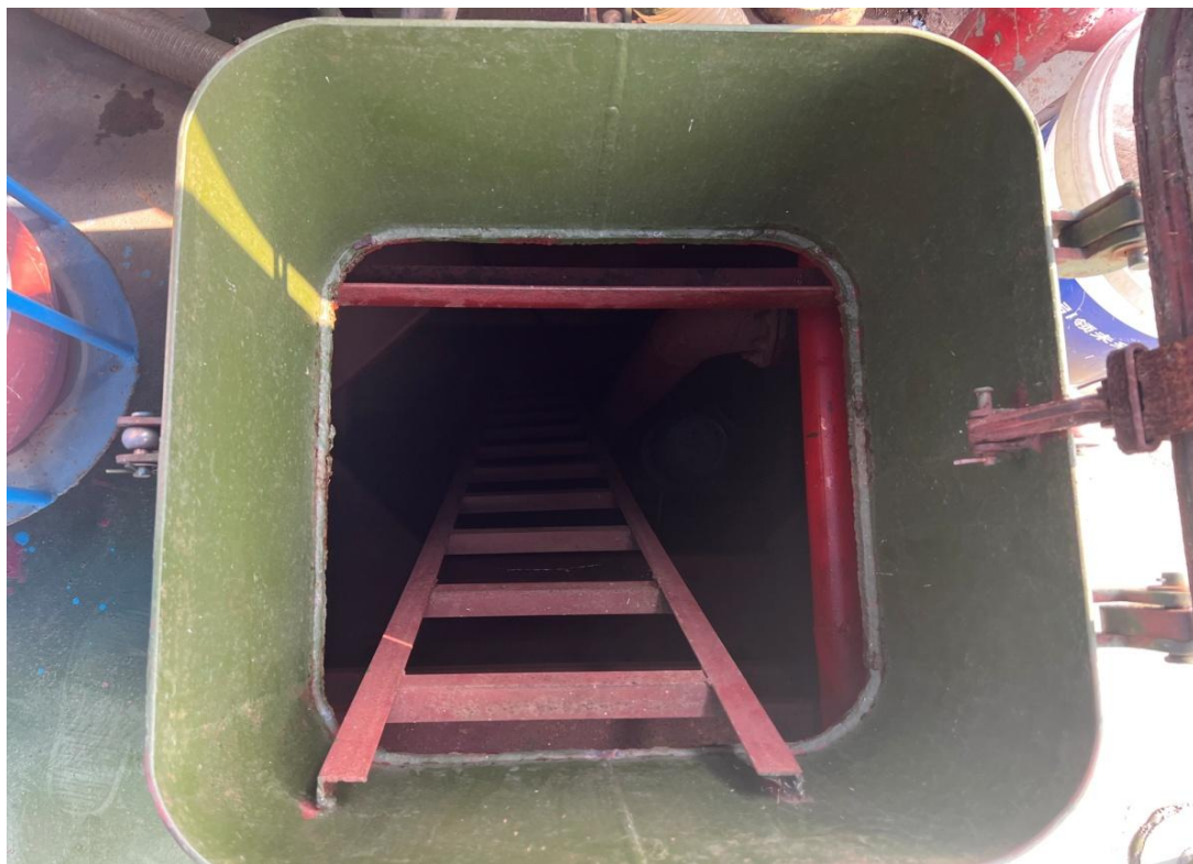
图 2：事发时“粤韶关货 XXXX”船尾左舷污水舱舱口状态
