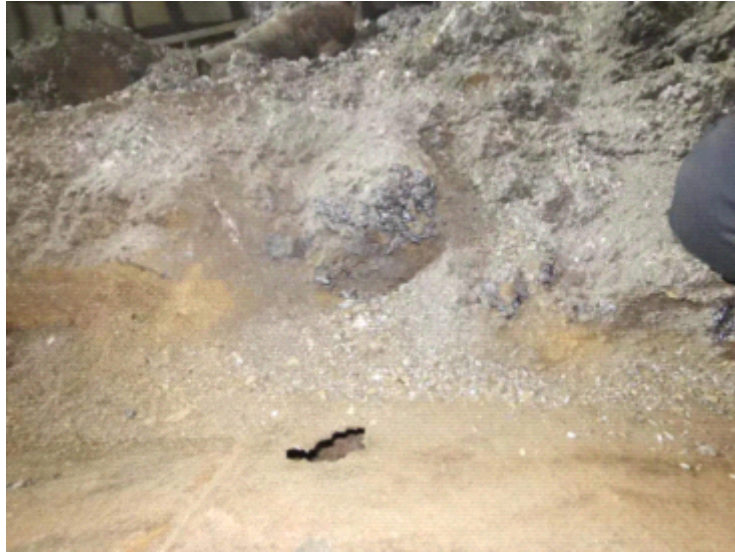
图19.“辽 F6707挂”车厢底板不规则孔洞及硅泥烧损断层情况
