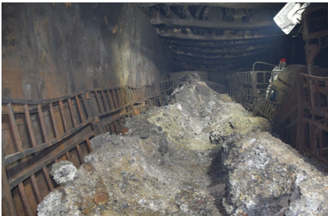
图11.“辽 F6707挂”车厢烧损情况（由后向前拍摄）
