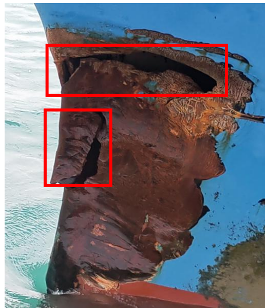
图 4：“海丰岷港”轮水线以上刮擦破损痕迹（现场勘查照片）
