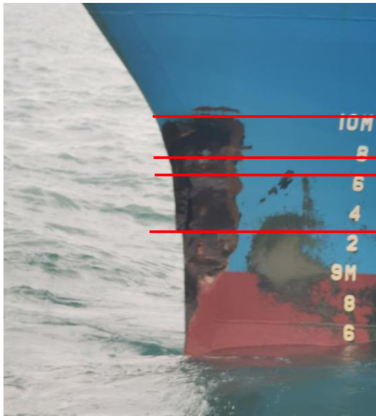
图 4：“海丰岷港”轮水线以上刮擦破损痕迹（现场勘查照片）
