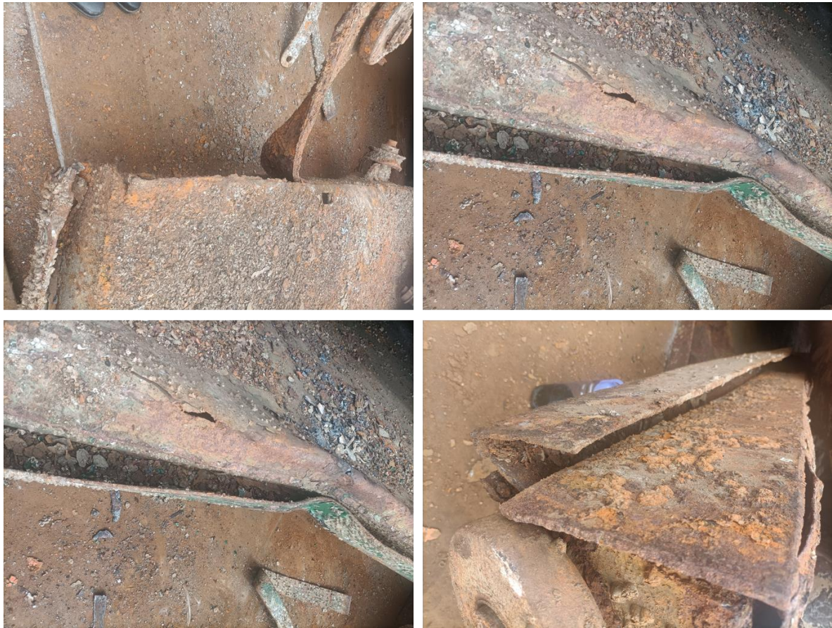
图 9：“翔瀚 88”轮打捞起的货舱盖凹槽照片
