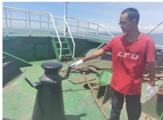
图 3、4：艏楼甲板左侧导缆轮
