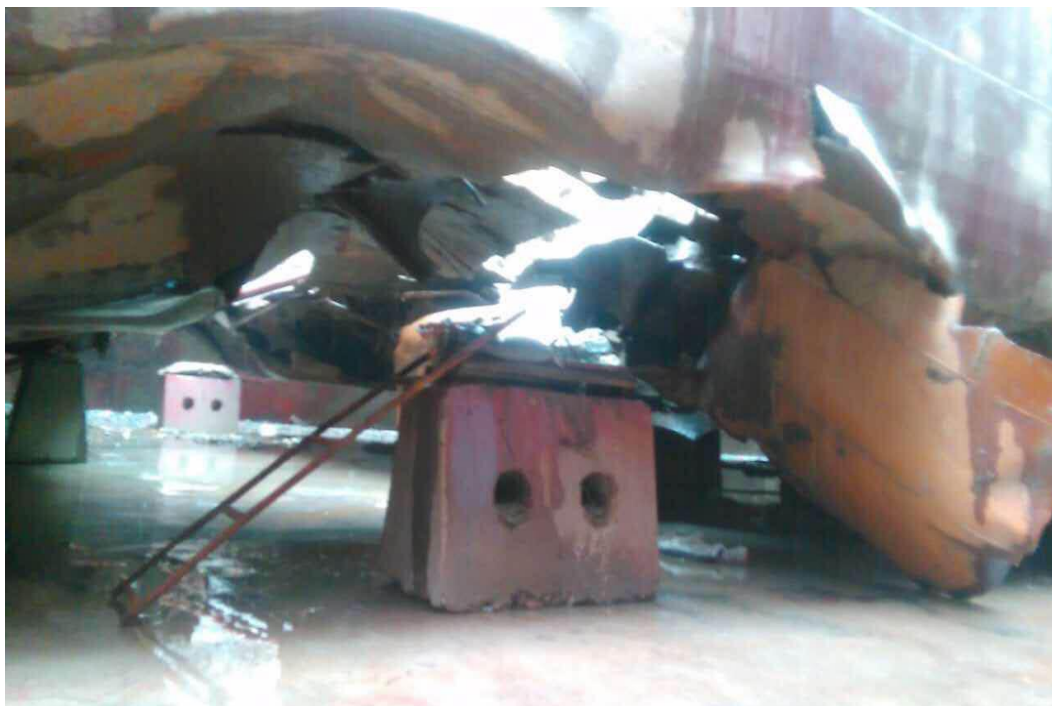
图 4：“安强 19” 船 1 号货舱破损情况（进坞后拍摄）
