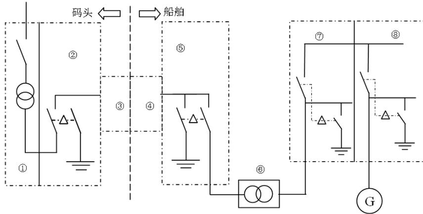
①港口高压供电系统(包含变压器)；②港口高压配电柜；③港口岸电插座箱；④电缆管理系统和电缆(带插头)；⑤岸电连接配电柜(板)；⑥变压器；⑦岸电接入控制屏；⑧主配电板发电机屏
