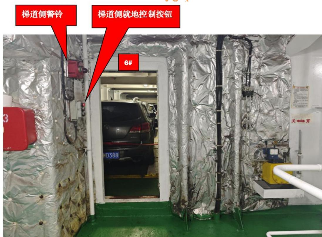
图 8：6#水密门梯道侧的就地控制按钮和警铃布置
