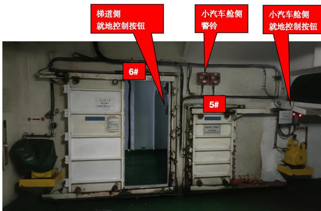
图 7：6#水密门小汽车舱侧的就地控制按钮和警铃布置
