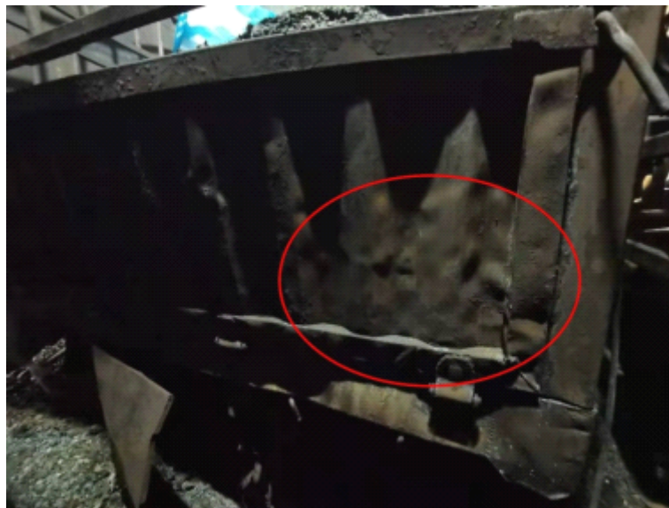
图15.“辽 F6707挂”车厢后挡板受热变形痕迹
