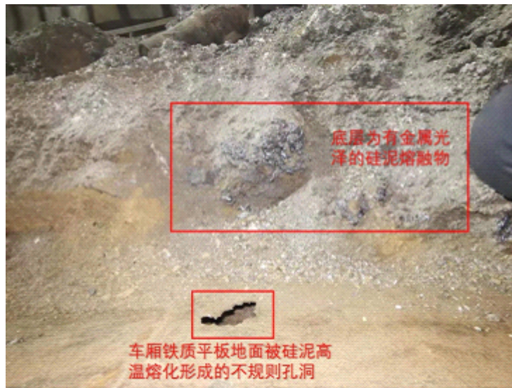
图14.“辽 F6707挂”车厢内货物燃烧产物
