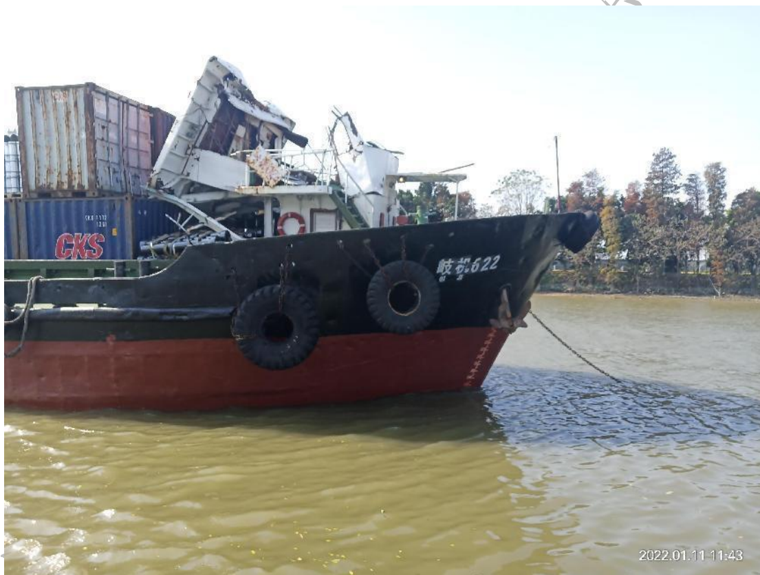
图 5：“岐机 622” 船驾驶台受损情况
