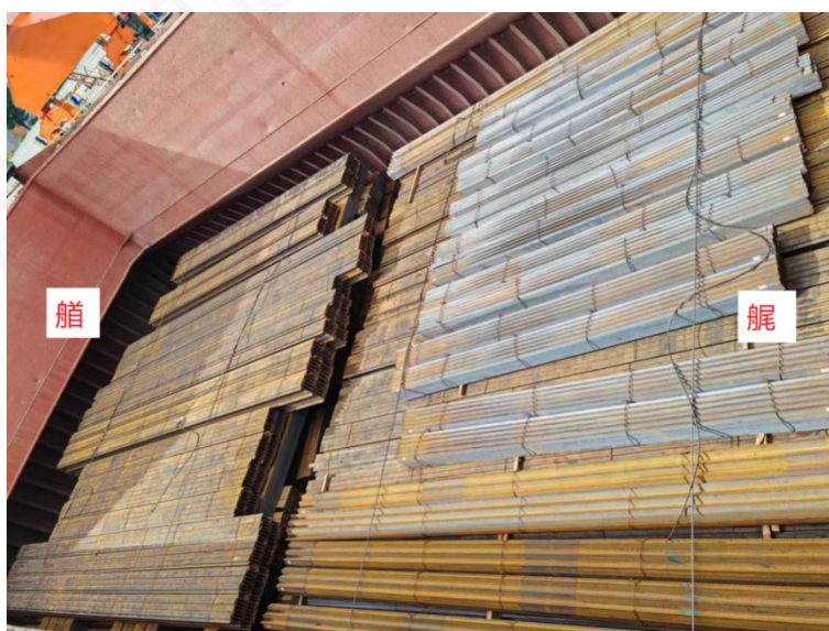
图 5：NO. 2 舱装载及绑扎情况
