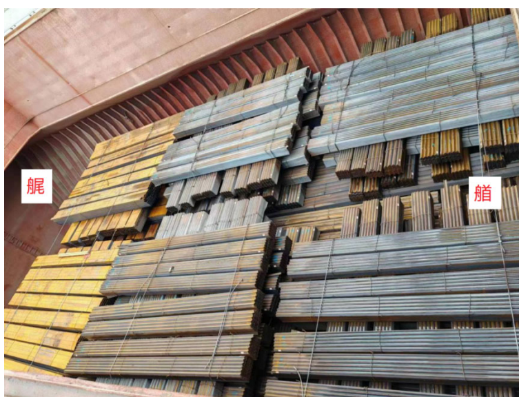
图 4：NO. 1 舱装载及绑扎情况
