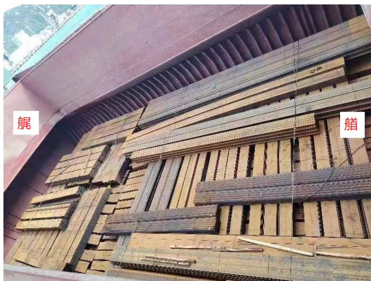
图 6：NO. 3 舱装载及绑扎情况
