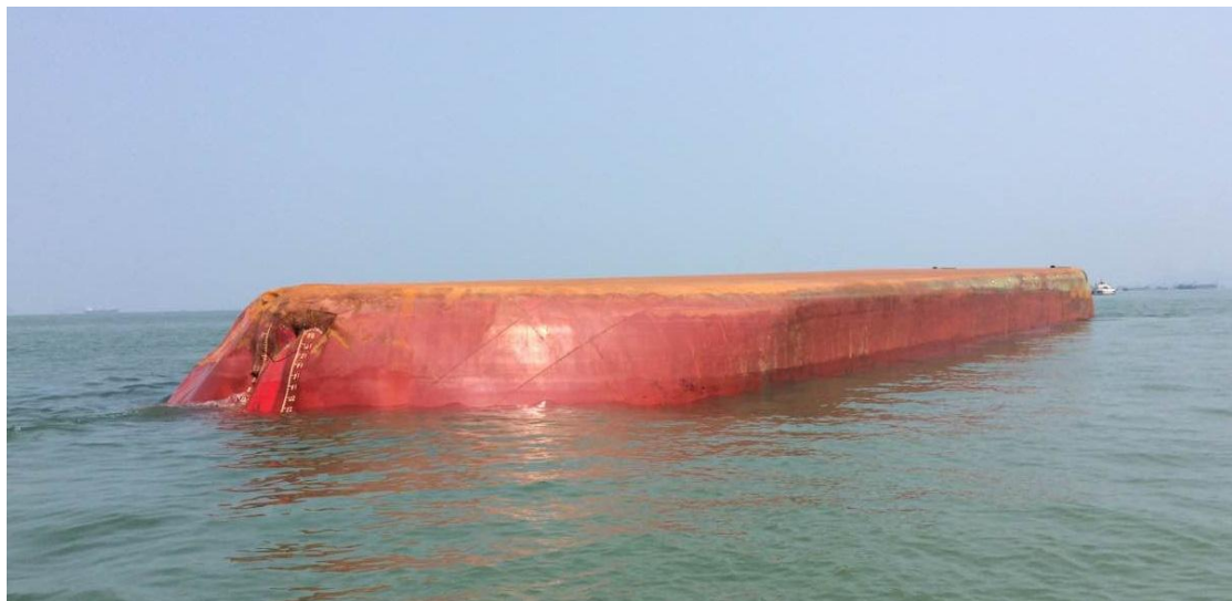
图 7：事故后“天力 968”船翻沉、船艏左侧船体破损情况
