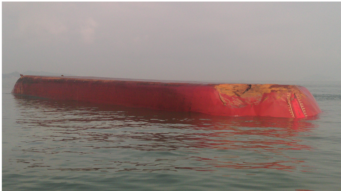
图 6：事故后“天力 968”船翻沉、船底破损情况
