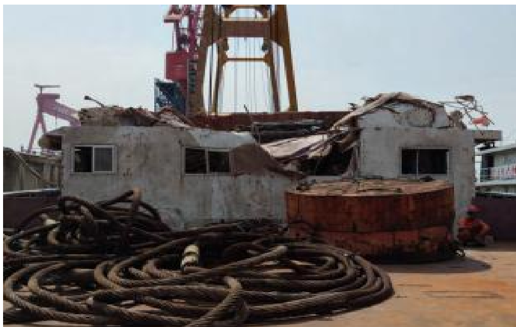
图16: “旭航588”轮驾驶室受损照片
