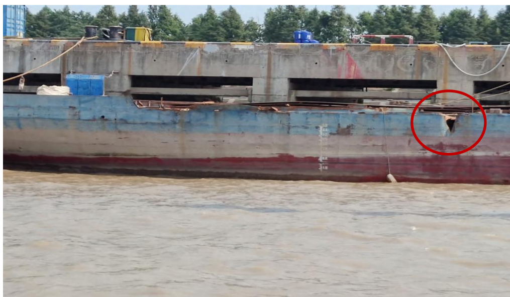
图14：“旭航588”轮右舷中部破口照片
