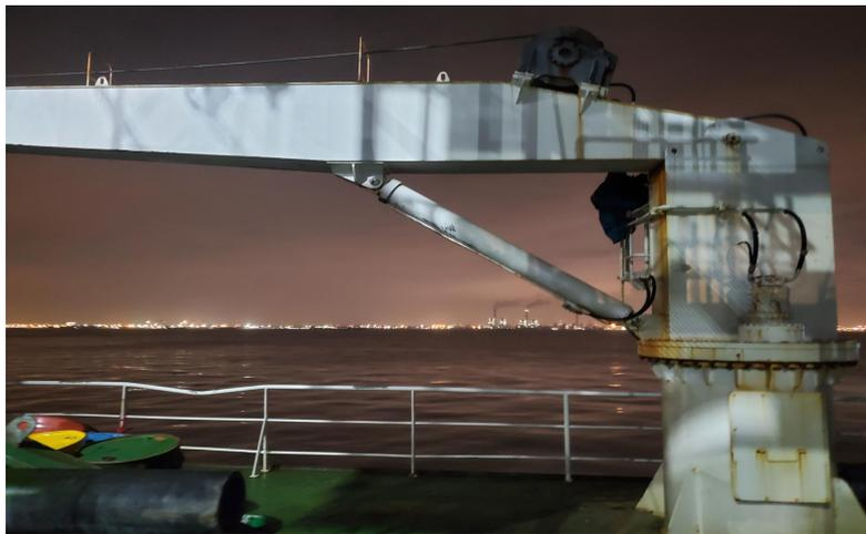
图 15：浮球固定的吊机基座和栏杆（栏杆已弯曲）
