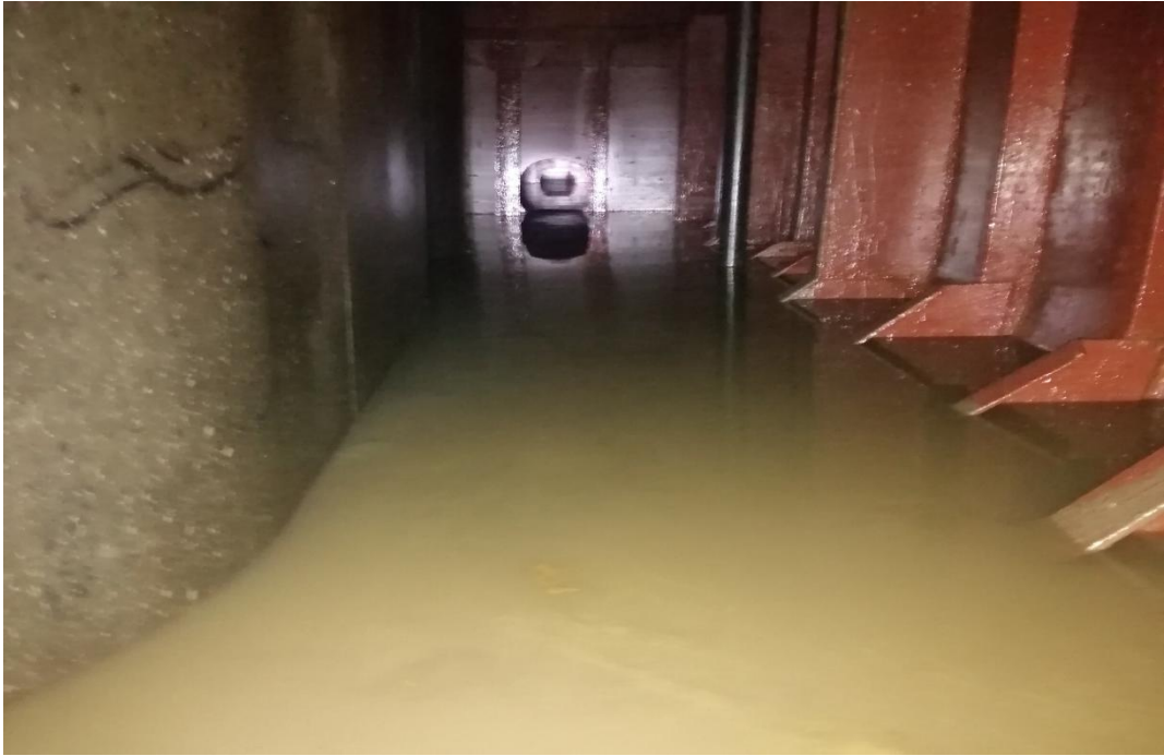
图 6：“宇”轮货舱之间的横舱壁左侧部位人孔
