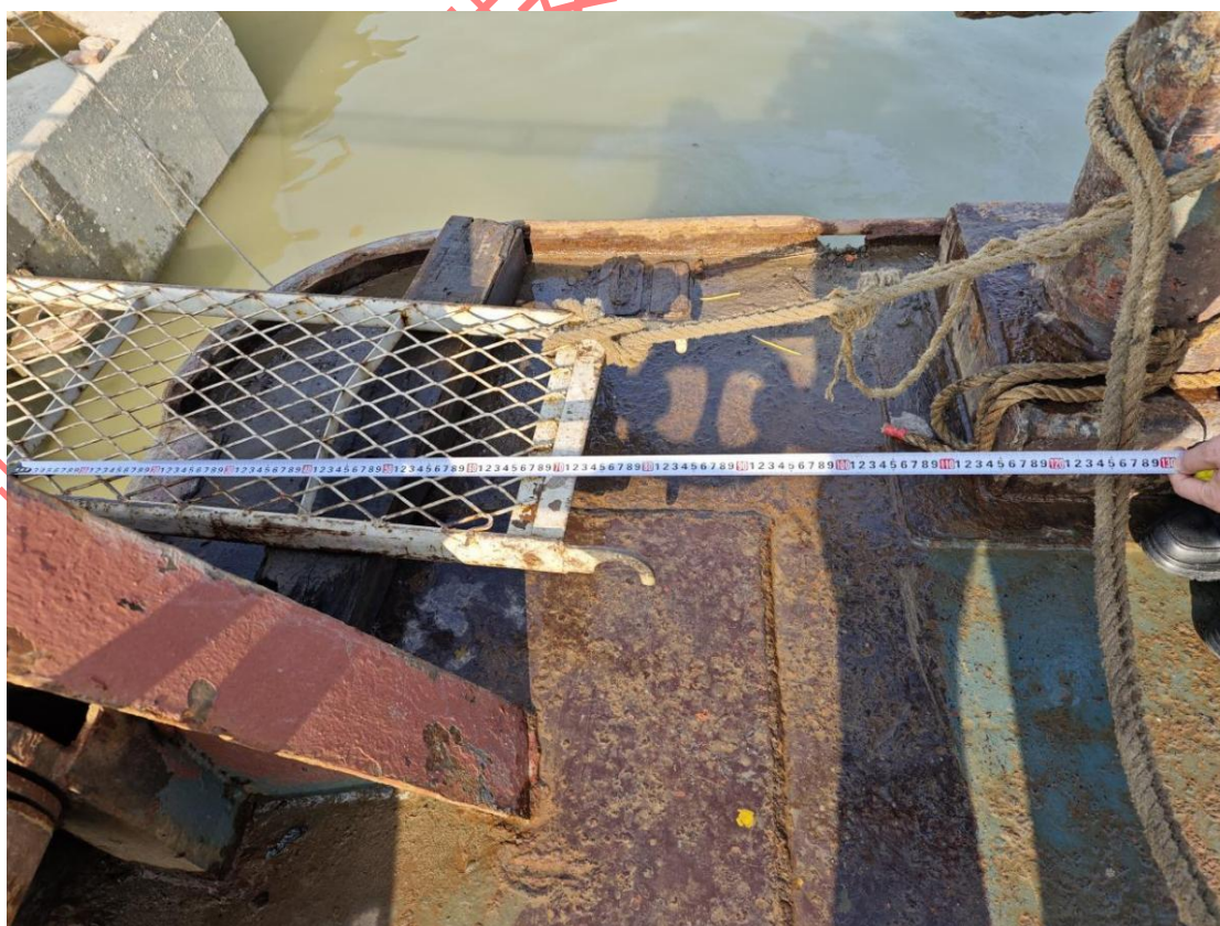
图 4：连接绳与船首端部横向距离为 130cm
