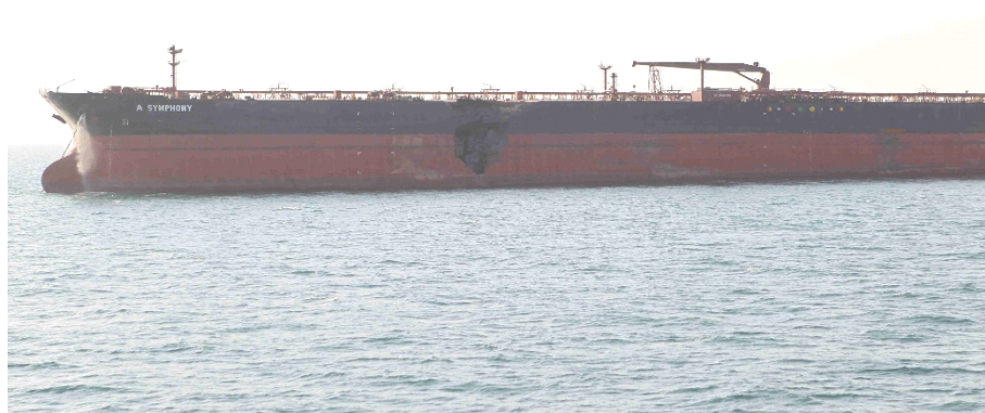
图 17 过驳作业结束后“交响乐”轮破损位置露出海面
