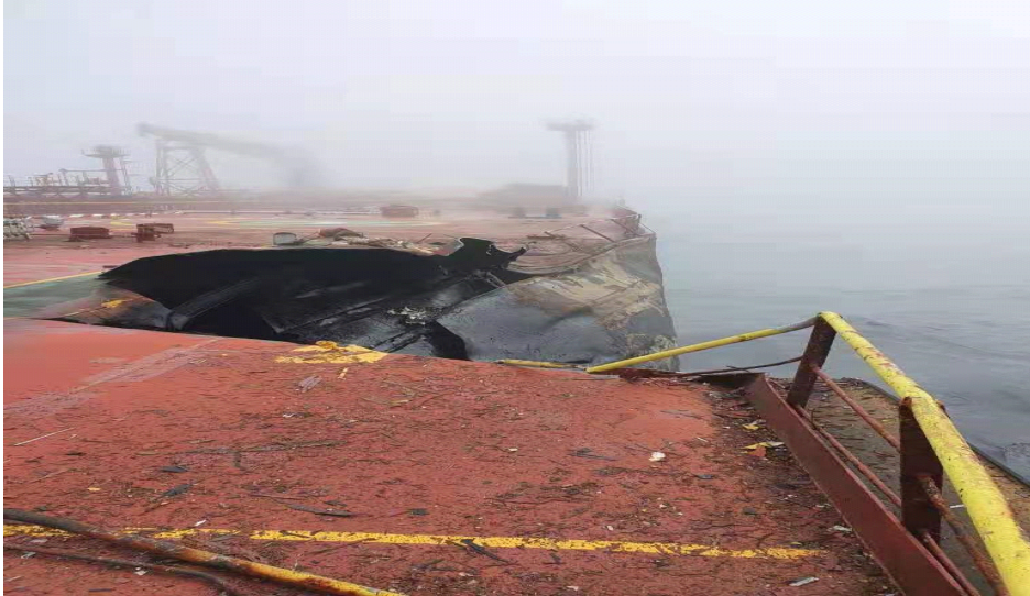
图 15 碰撞发生后“交响乐”轮破损情况
