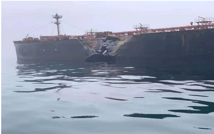
图 16 碰撞发生后“交响乐”轮破损溢油情况
