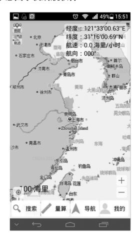
"海e行"是中国首款以电子航海示意图为依托、为小型船舶及个人用户提供公益性服务的海上移动助航软件。免费为广大使用手机或平板电脑的航海用户提供电子海图浏览、航线绘制、海上定位及助航、航迹查询等服务。
