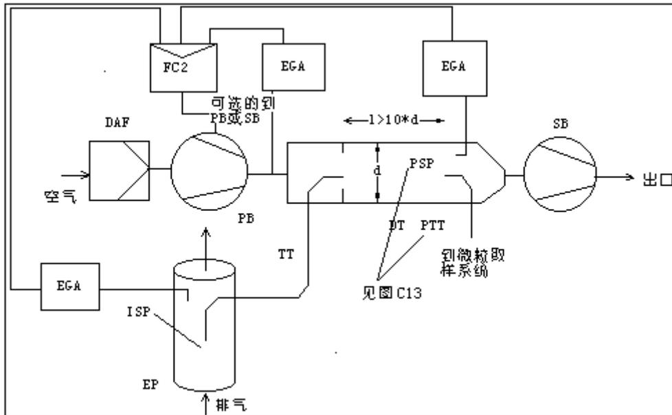
图 4.5 带  $\text{CO}_2$  和  $\text{NO}_x$  浓度测量和部分流采样的部分流稀释系统
