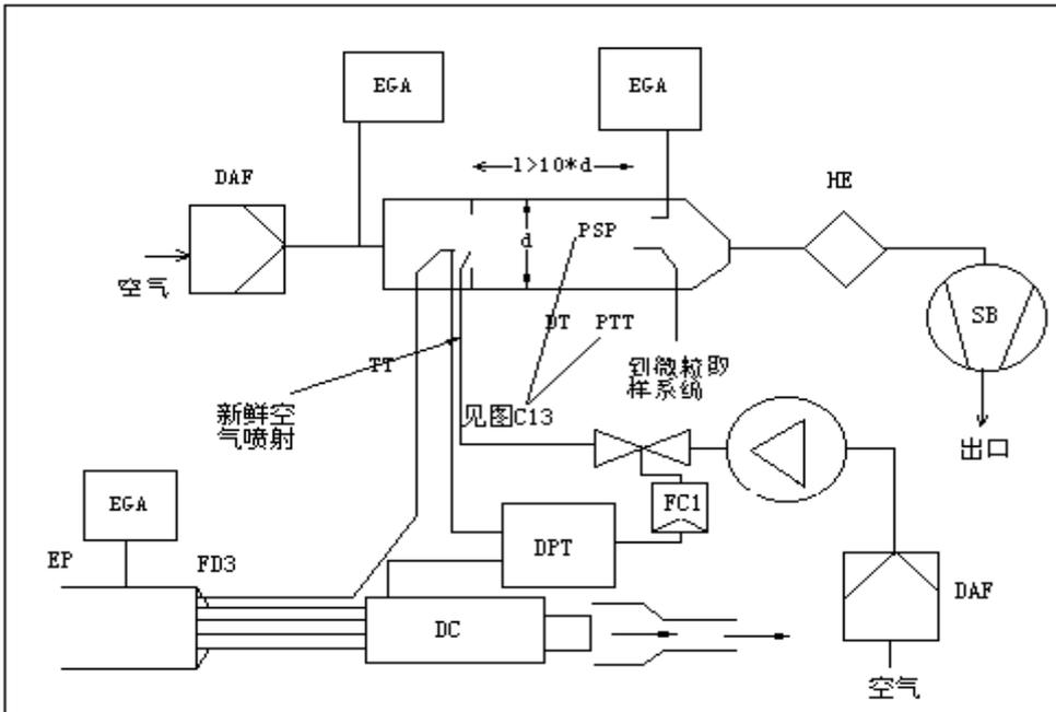
图 4.9 带多分管、浓度测量，部分流取样的部分流稀释系统
