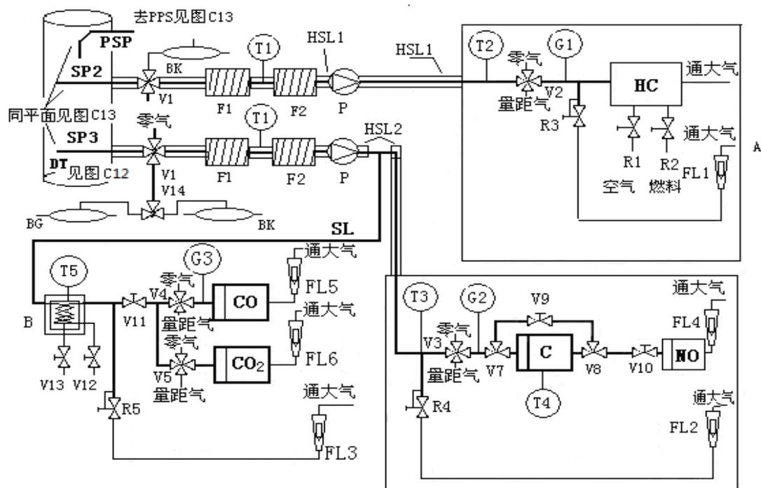
图 4.2 测量稀释排气的 CO、CO<sub>2</sub>、HC 和 NO<sub>x</sub> 分析系统流程图
