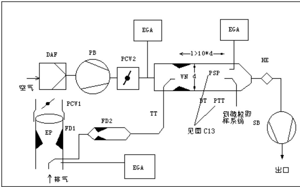
图 4.8 带双文丘里管或双流量孔，浓度测量，部分流取样的部分流稀释系统
