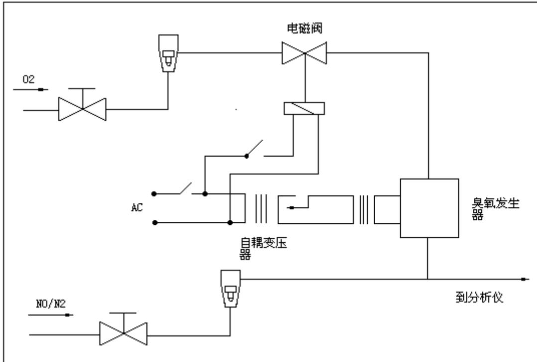
图附录 6.1 NO<sub>2</sub>转换效率设备流程图
