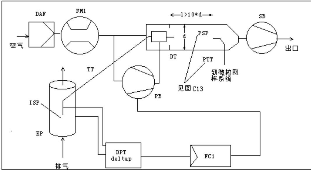
图 4.4 带等动态探头和部分流采样的部分流稀释系统 (PB 控制)
