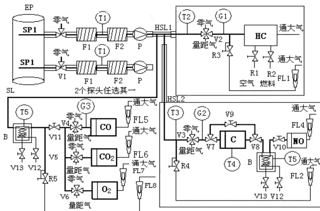
图 4.1 测量原始排气的 CO、CO<sub>2</sub>、O<sub>2</sub>、HC 和 NO<sub>x</sub> 分析系统流程图
