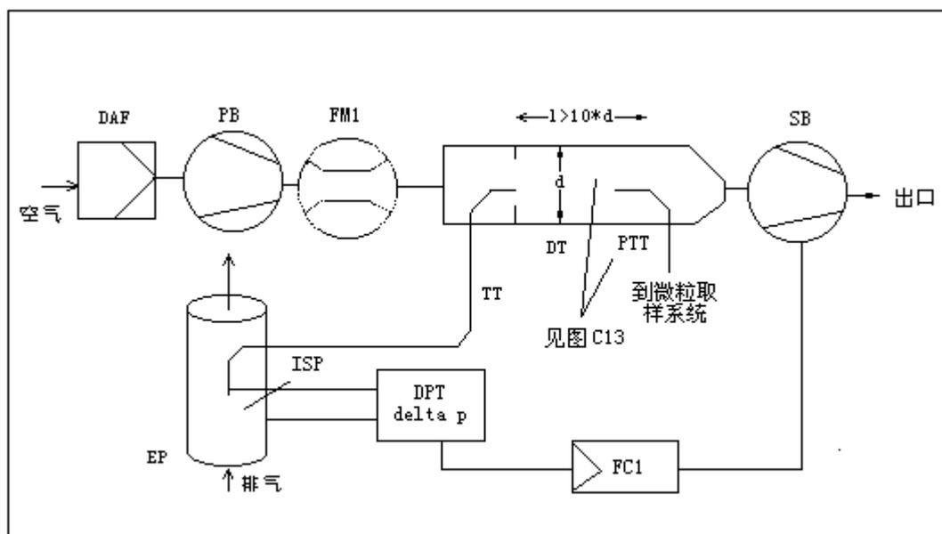
图 4.3 带等动态探头和部分流采样的部分流稀释系统(SB 控制)
